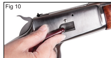
L'arme est chargée par le port de chargement
